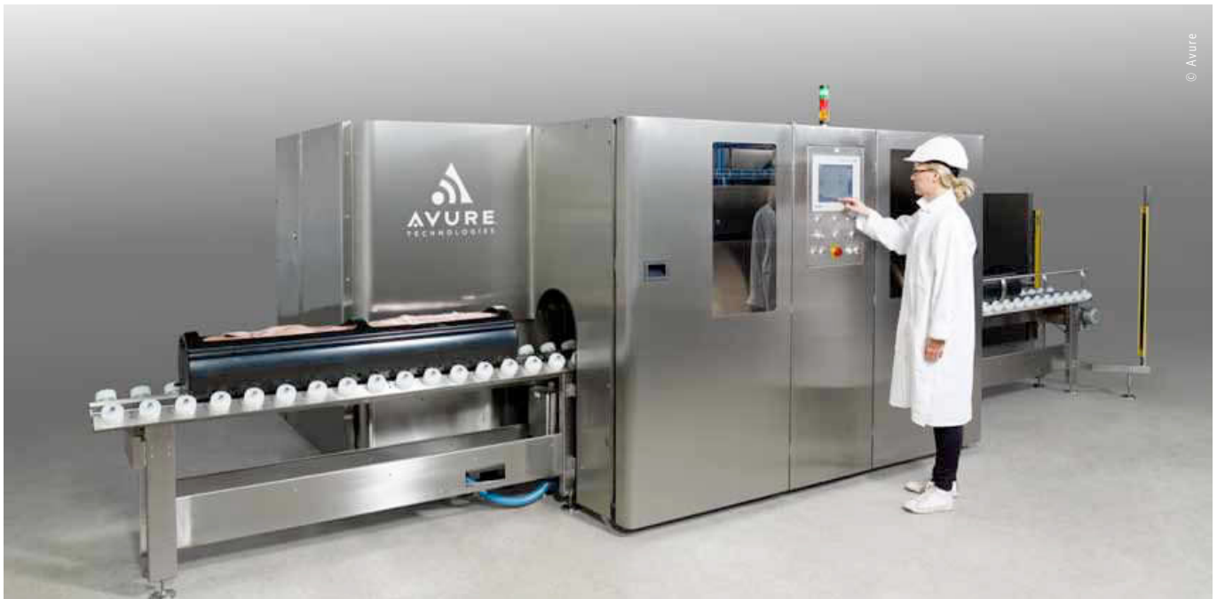
Esempio di macchinario per stabilizzare gli alimenti ad alta pressione
